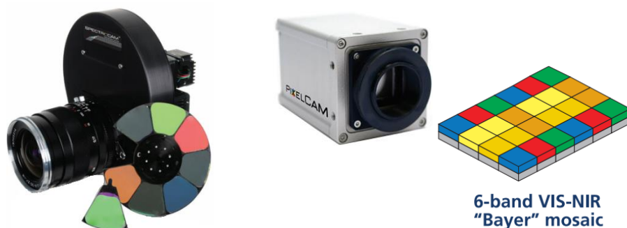
Obr. 14 - Porovnání konstrukce staring multispektrální kamery s filtrovým kolem (136 x 124 x 105 mm) [34] a snapshot multispektrální kamery s mozaikovou strukturou filtru (52,5 x 52,5 x 79,4 mm) [35]
